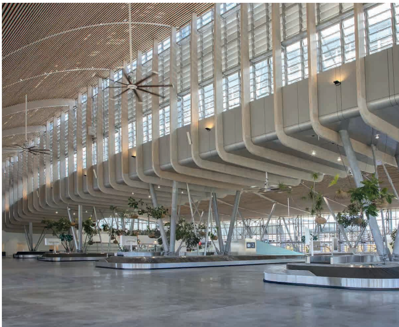
L'intérieur de l'Aéroport Roland-Garros de la Réunion. Sa structure bioclimatique en forme de vague favorise un effet Venturi qui rafraîchit l'air. (DR)
