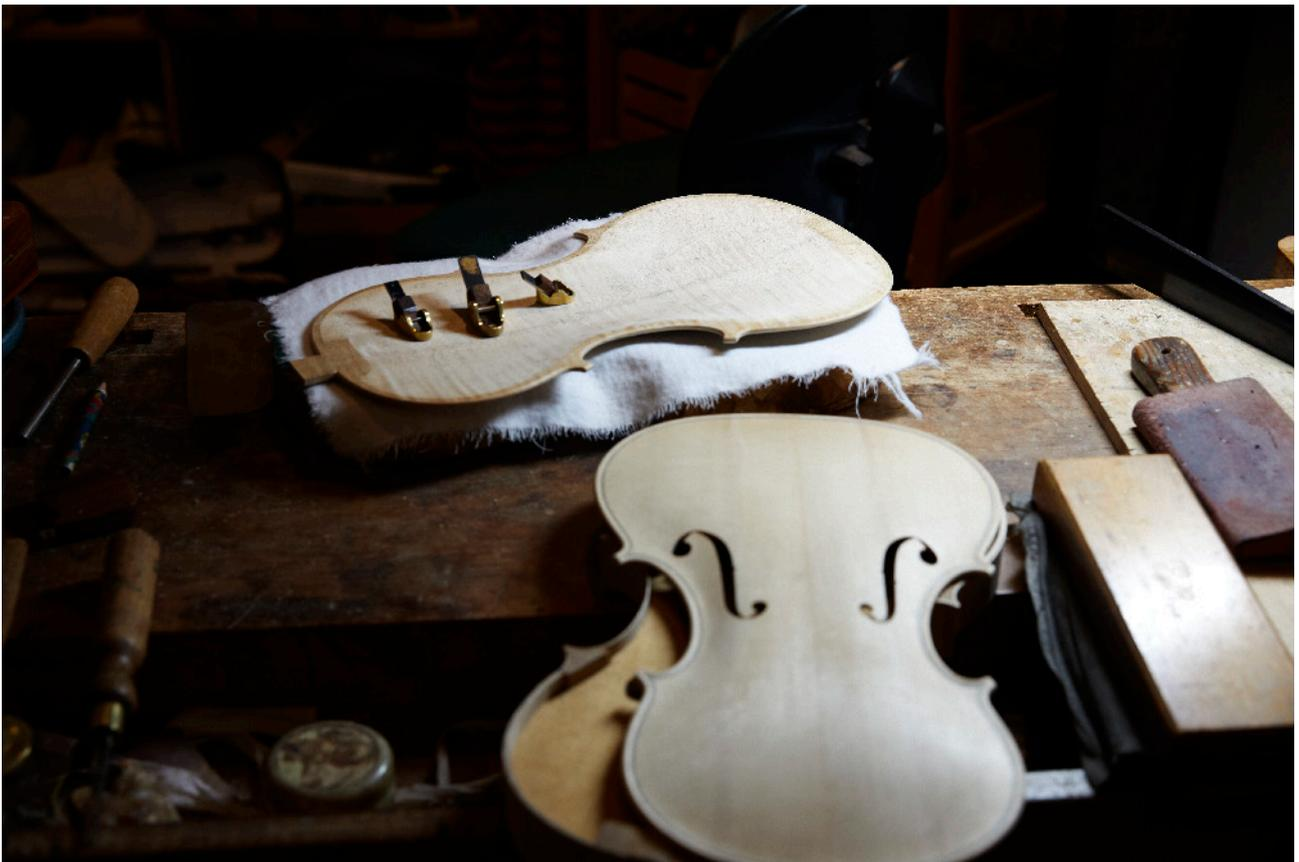
Le dos et la table d'harmonie d'un instrument. Le premier est taillé dans un bloc d'érable, le second dans celui d'un épicéa.
